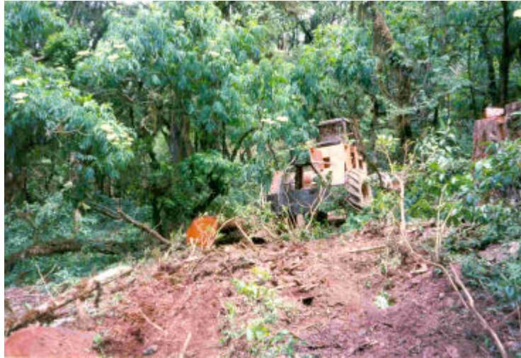
Foto N° 3: Topadora para arrastre de rollos
