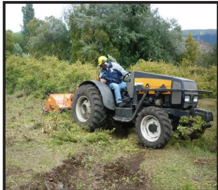
En primera instancia se intentó controlar arbustos de gran porte (>2,5 m. de altura), atacándolos en reversa, con la herramienta lo más levantada posible. Se logró la eliminación aunque con una demora mayor a 5 minutos/planta. Luego se procedió a optimizar el uso del tiempo por unidad de superficie a fin de realizar otros cálculos. Para ello se seleccionaron áreas
