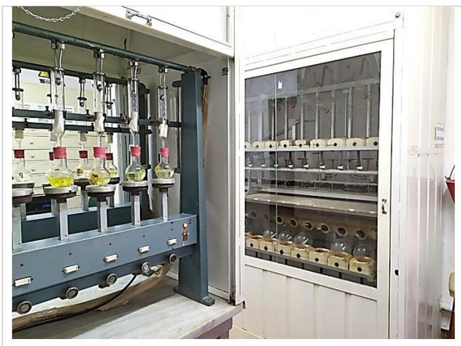
*Equipos Butt para determinación de aceite y Kjeldahl para determinación de proteínas por método químico*
