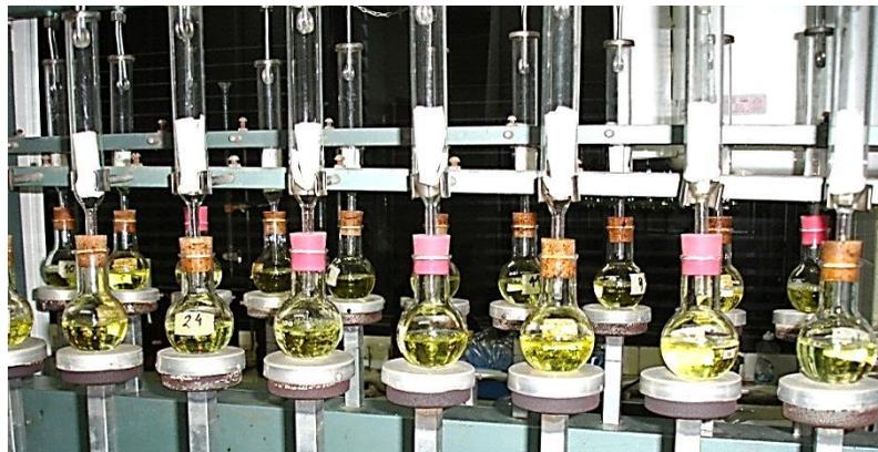
*Equipo Butt para extracción de aceite por solvente*
