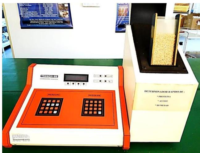
*Equipo NIRT Trebor 99 para la determinación en grano entero de proteína, humedad en trigo y proteína, humedad y aceite en soja. 1987.*
