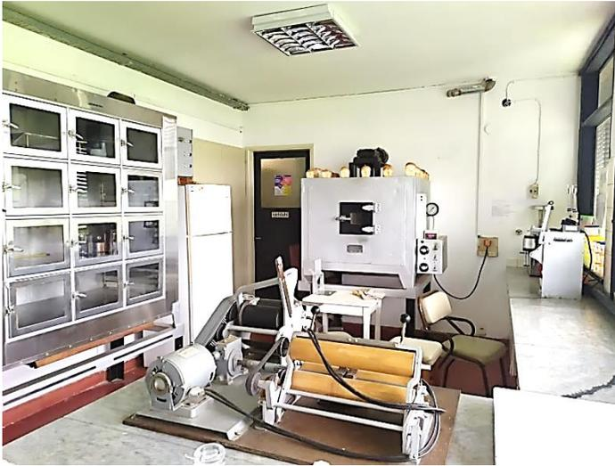
*Lab. de Panificación: amasadora, moldeadora, fermentadora, horno eléctrico y medidor de volumen*
