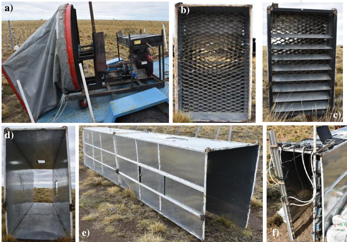
Figura 4.12. Túnel de viento portátil funcionando en el campo y detalle de sus partes. a) motor sobre carro y segmento que lleva la hélice, b) placa cribada, c) chapas deflectoras, d) tramo del túnel con piso, e) zona de medición y f) salida del túnel con colectores y anemómetros.
