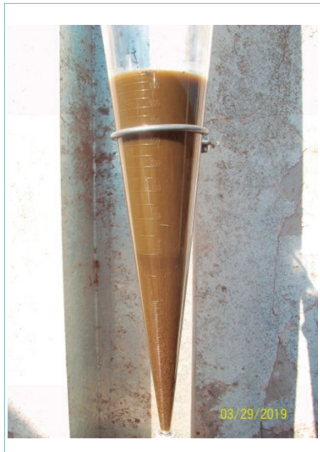
Foto 4. Cono Imhoff: elemento utilizado para determinar Sólidos Sedimentables.
