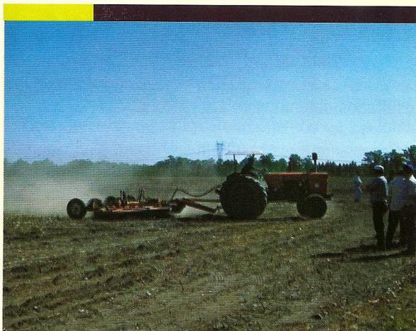
■ Fig. 9. Destrucción del rastrojo con desmalezadora.
