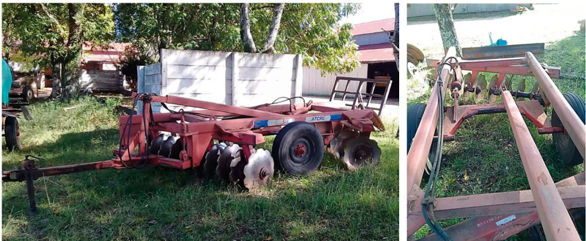
■ Figura 3.2. Rastra de discos utilizada comúnmente en la labranza del suelo para plantación de eucalipto.
