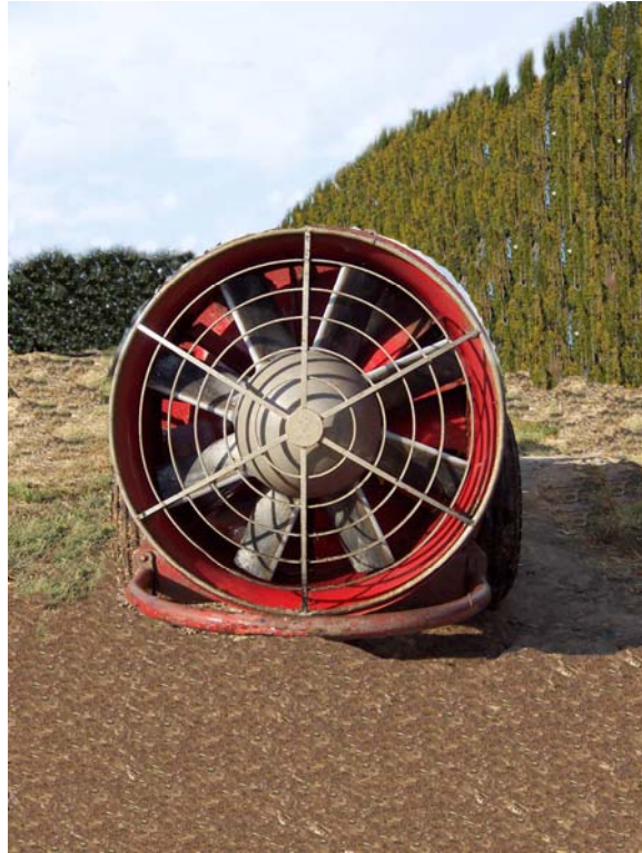
Figura 18: Ventilador axial de pulverizadora hidroneumática
