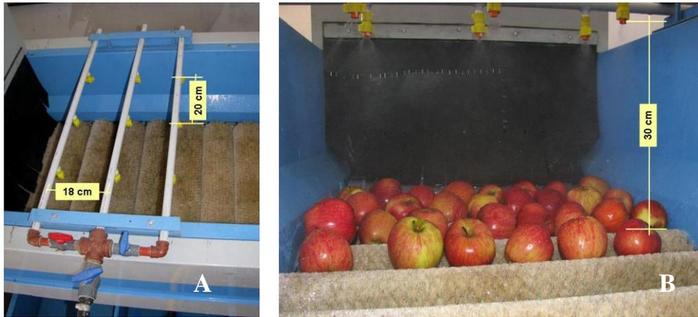
**Figura 3.3.** Sistema con boquillas de pulverización. **A:** Vista superior; **B:** Vista frontal.
