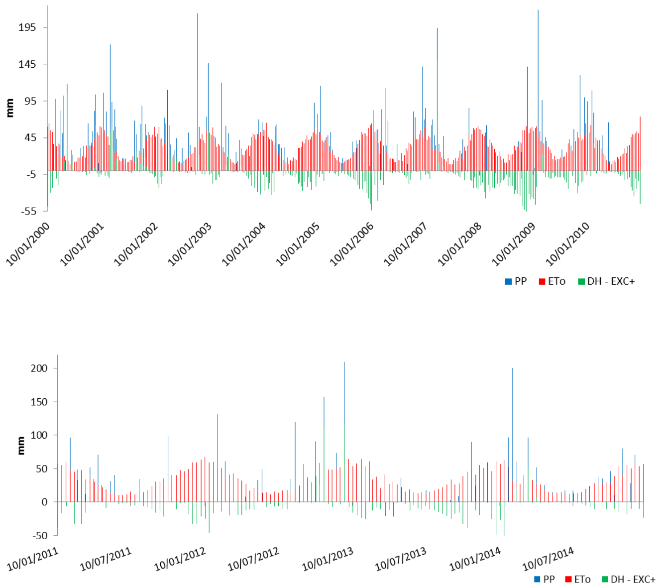
Figura 8: Resultados del Balance Hídrico Seriado decádico. Período 1974-2014. Ref.: PP: Precipitaciones, ETo Evapotranspiración de referencia, DH: Deficiencias Hídricas y Exc: excesos hídricos.
