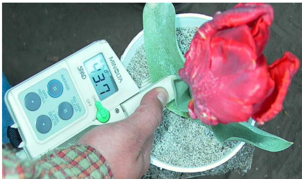
Figura 2.2.6: Al momento de plena floración se efectuó la medición del contenido de clorofila a través del clorofilómetro SPAD-502 de Minolta
