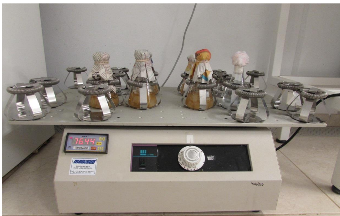
Figura 6. Agitador orbital de erlenmeyers con micelio de aislamientos en caldo de papa, creciendo en agitación en condiciones de laboratorio a 25\text{ }^{\circ}\text{C} \pm 2 y luz natural.
