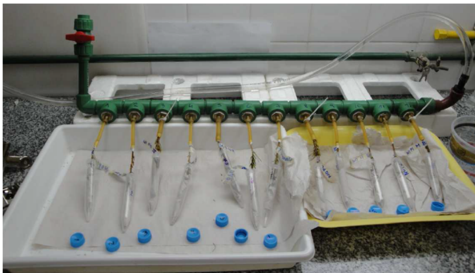
Figura 2b.3: Vista del conductímetro multicanal durante las mediciones de conductividad hidráulica del tallo.
