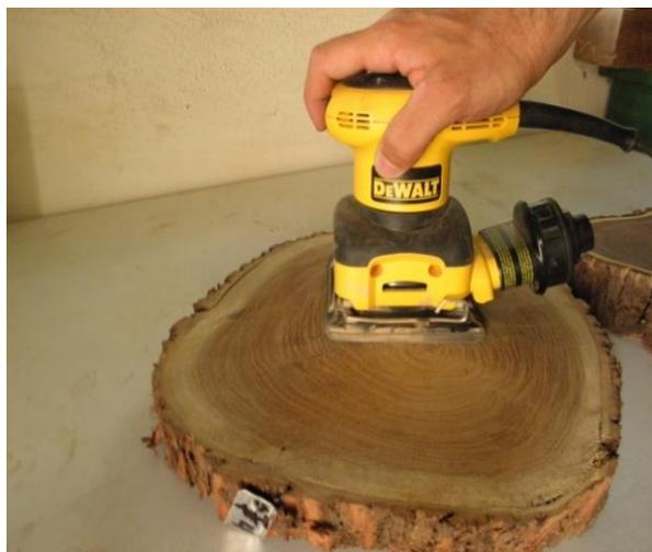
❖ **Figura 24. Izq.: Lijado de muestras con lijadora orbital. Der.: Paso a paso del lijado.**
