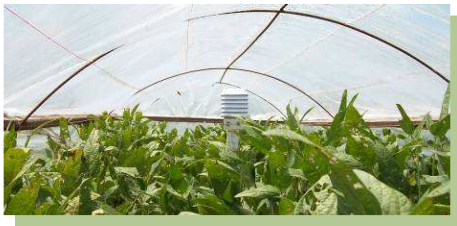
Figura 3.3: Vista del sensor de temperatura y humedad relativa dentro de una carpa.
