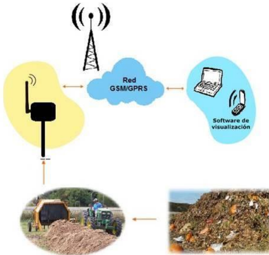
Figura 20. Diagrama esquemático del funcionamiento del sistema de telemetría para el monitoreo de las pilas de compost.
