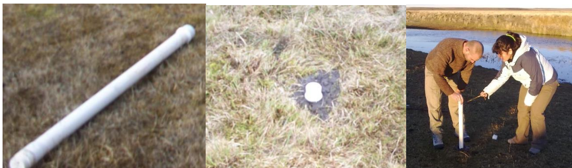
Figura 3.1. Instalación de freatómetros.
