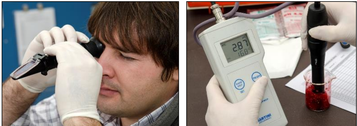
Figura 3.6. Medición de sólidos solubles (grados brix) mediante la utilización refractómetro de mano (izquierda) y medición de pH mediante la utilización de peachímetro portátil (derecha).
