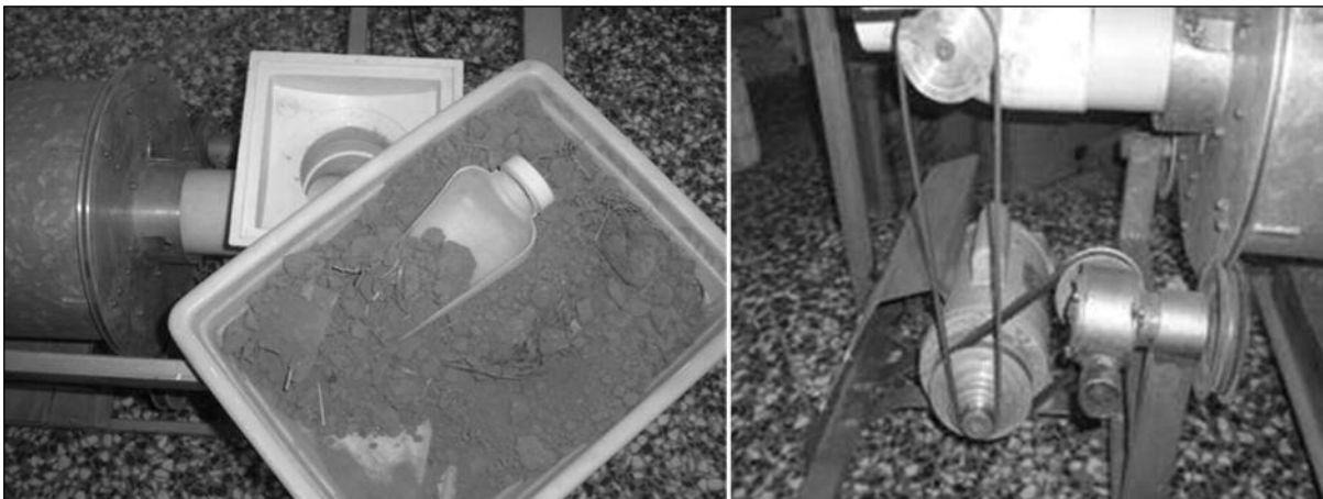
Figura 4. Bandeja con muestra y pala de alimentación (izquierda) y detalle del motor y las poleas (derecha).
