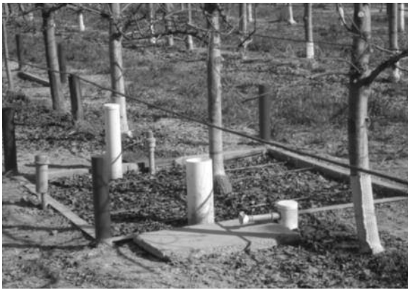
Foto 1. Lisímetro de pesada en cultivo de vid. Foto 2. Lisímetro de drenaje en cultivo de pera. Gentileza: INTA-EEA Mendoza y EEA Alto Valle Río Negro
