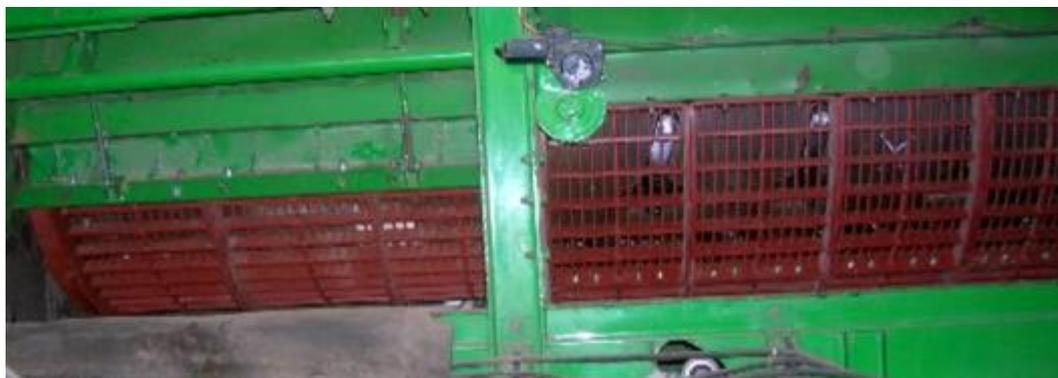
**Figura 4.** Cóncavos de trilla y separación experimentales, utilizados para el ensayo en ambas cosechadoras JD.
