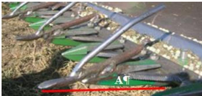
**Figura 3.** Distribución de los levanta mieses cortos sobre la barra de corte y de su alineación, respecto del puntón (punto A).
