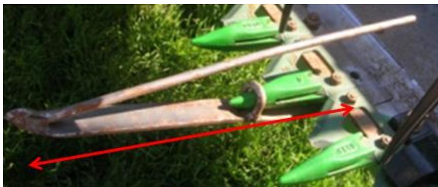
**Figura 1.** Vista de un levanta mieses ensayado en cosecha de garbanzo, de 30cm de longitud.
