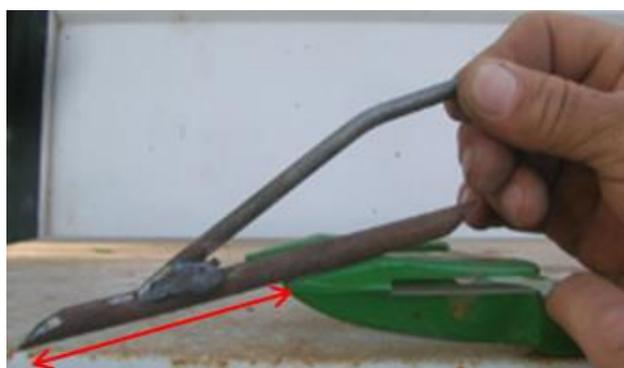
**Figura 2.** Vista de un levanta mieses corto de 6 cm de longitud
