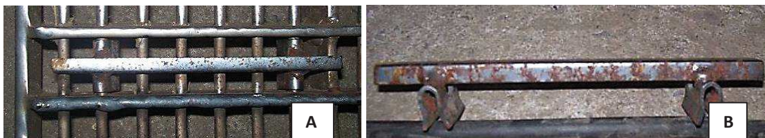
Figura 17. A) Barra insertada entre las barras de fricción del cóncavo de trilla. B) Vista de las pinzas de fijación, en los alambres de la grilla de colado de los cóncavos de trilla.
