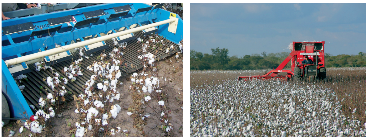
Figura 12. Cosechadora Javiyú con sistema stripper . A la izquierda se observa el cabezal de cosecha avanzando oblicuamente a la dirección de los surcos. A la derecha se visualiza la Javiyú cosechando un lote de algodón sembrado a surco estrecho.
