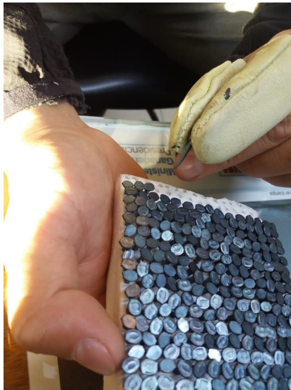
Fig. 3. Plancha de telgopor con tachuelas para traslado y colocación de fajas en el campo.
