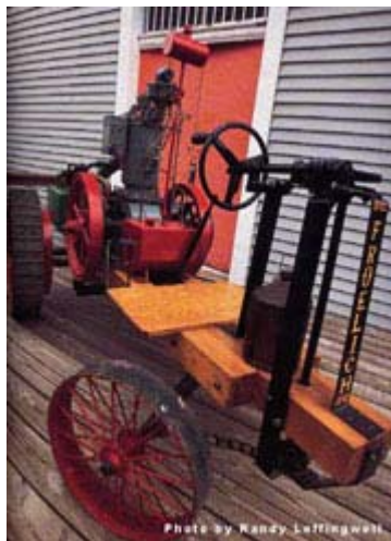
Figura 1.1.4.1. Réplica del primer tractor agrícola construido por Froelich.
