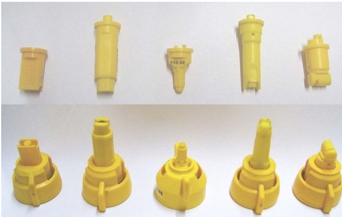
Figura 2.2. Pastillas de baja deriva asistidas por aire empleadas en la prueba. De izquierda a derecha: Agrotop Airmix Nodrift, Teejet Air Induction, Hypro Guardian AI, Lechler ID, Turbo Teejet Induction.
