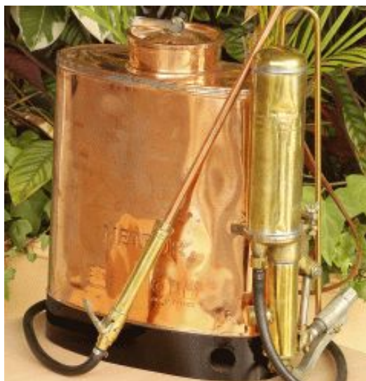
Figura 1.1.4.2. Equipo pulverizador manual (mochila) de 1887.
