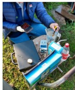
Figura 2.- Equipo multiparamétrico.
