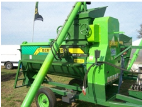
Módulo de molienda y mezcladora horizontal transportable para carga en comederos - FERICERDO.
