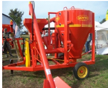
Módulo de molienda sobre chasis con mezcladora vertical transportable - FERICERDO.
