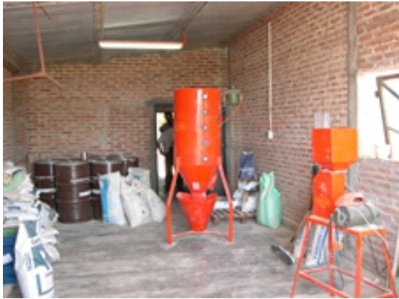
Moledora y mezcladora monofásico - Sáenz Peña - Chaco.
