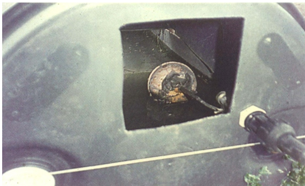
Bebedores de bidones (descartados) con flotante.
