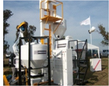
Planta modular de alimento balanceado en polvo - FERICERDO.
