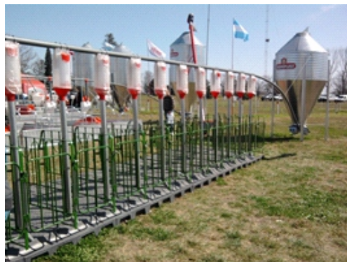
Jaulas de partos con distribución mecánica de alimentos - FERICERDO.
