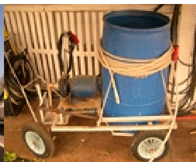
Tanque de lavado y desinfección.
