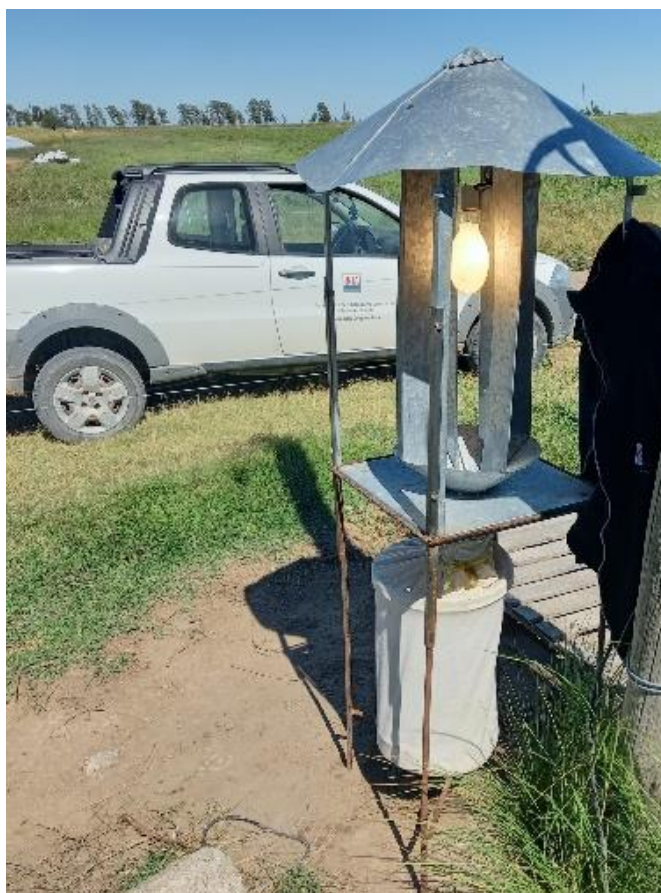
Figura N°1: Trampa de luz instalada en Villalonga.
