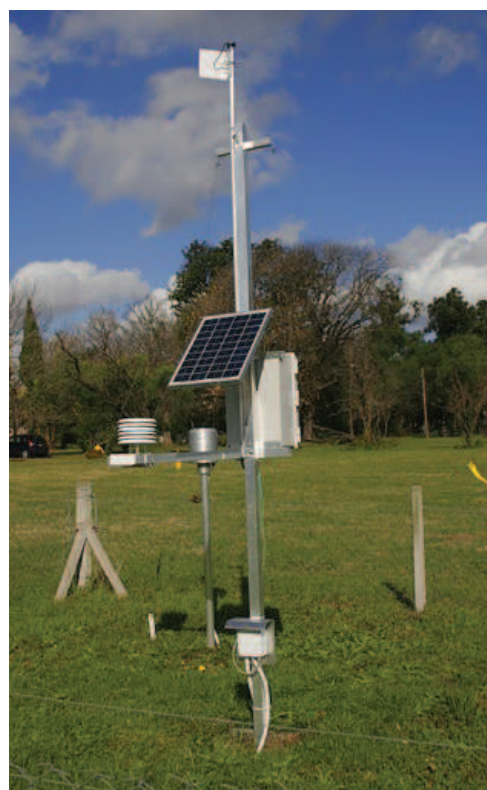
Figura 6. Estación Agrometeorológica Automática Nimbus THP (INTA-UTN)
