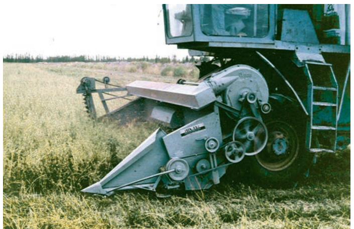
FIGURA 9: Cosechadora con plataforma provista de picos sopladores (air jet) y cuchilla de corte vertical.
