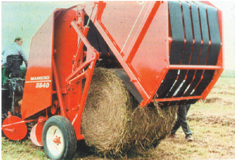
FIGURA 5 – Rotoenfardadora de alfalfa que produce rollos de núcleo compacto.
