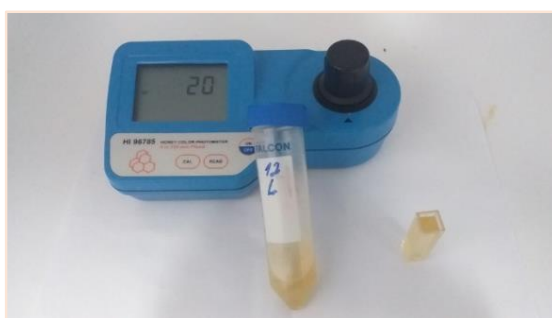
Figura 2. A. Color de mieles provenientes de diferentes floraciones. Figura 2. B. colorímetro portátil para medir color de miel (Hanna). Fotos Romina Castro, 2020.
