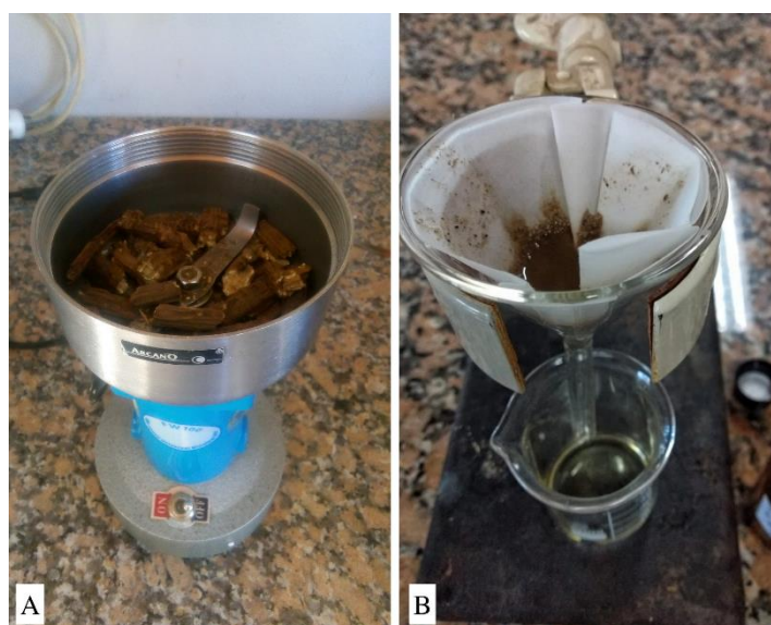
Figura 38. A) molienda del material seco. B) filtrado de los extractos.
