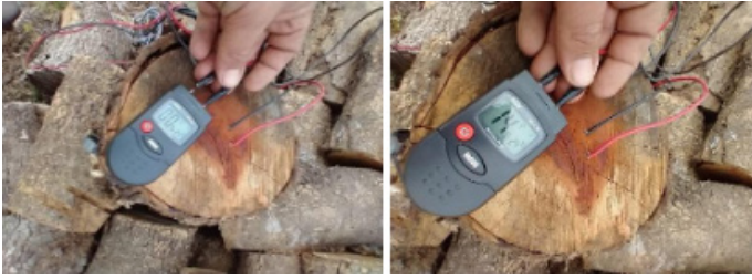
Figura 1: Medición de humedad con xilohigrómetro y alargadores en muestra de leña
