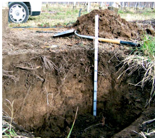
Figura 8. Calicata donde se observa una concentración superficial de raíces
