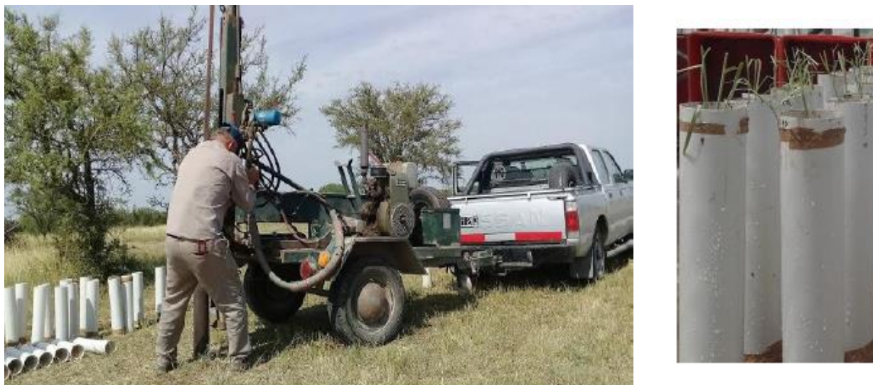
Figura 1. A la izquierda se muestra el momento de extracción de suelo mediante un barreno hidráulico para obtener el perfil completo en el campo de un productor con suelo salino. A la derecha, se ven las plantas creciendo en los tubos de PVC con el suelo salino en el invernadero
