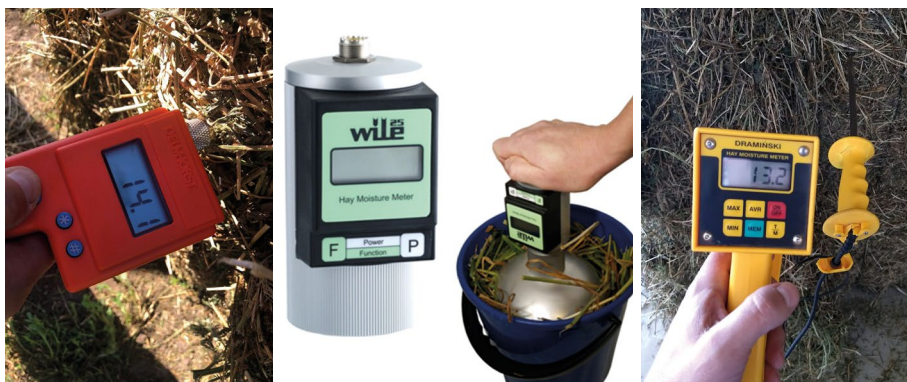
■ Figura 12. Distintos modelos de humidímetros manuales, que estiman el porcentaje de humedad de la fibra a partir de los valores de conductividad eléctrica que miden. En general, trabajan con precisión adecuada dentro de un rango de contenido de materia seca y compactación de la fibra.
