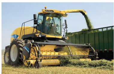
■ Figura 20. Picado de alfalfa previamente cortada y preoreada para la confección de silaje o henolaje. Foto: gentileza de la firma New Holland.
