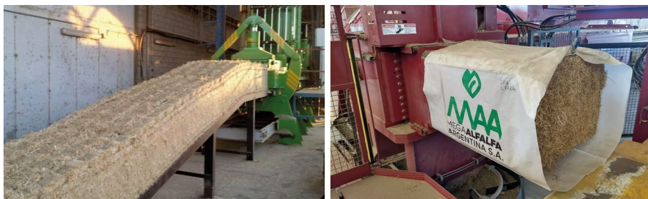
■ Figura 20. Izquierda: modelo de prensa compactadora de heno de la firma Imabe Iberica (España). Foto: gentileza Apisa S. L., España. Derecha: modelo de prensa compactadora fabricado por Hunterwood (Canadá) y envoltura plástica del producto en la planta de la empresa Mega Alfalfa Argentina S. A.
