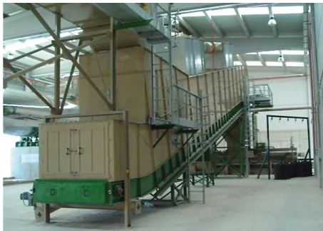
■ Figura 19. Túnel de enfriado por donde el material es expuesto a corrientes de aire frío. Foto: gentileza Apisa S.L., España.
