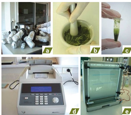
Figura 7. Preparación de material para extracción de ADN y posterior genotipado: a) liofilizado de muestras; b) molienda de muestras para posterior extracción; c) extracción de ADN; d) equipo para reacción de amplificación y e) cuba para corrida electroforética de geles de poliacrilamida. Fotos: Nancy Grandón.
