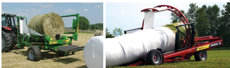
■ Figura 21. Confección de forrajes conservados húmedos sin picar como silopaq (izquierda) o siloline (derecha). Fotos: gentileza de McHale y Anderson.
