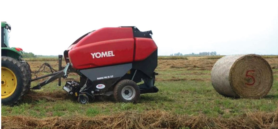
■ Figura 2. Materia prima secada a campo y empaquetada como megafardos (arriba) o rollos (abajo). El proceso tiene menores costos, pero mayor riesgo de pérdida de calidad por lluvias.
