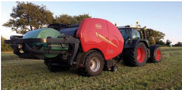
■ Figura 22. Rotoempacadora con gran capacidad de trabajo para la confección de silopaq. Foto: gentileza de Kverneland.
