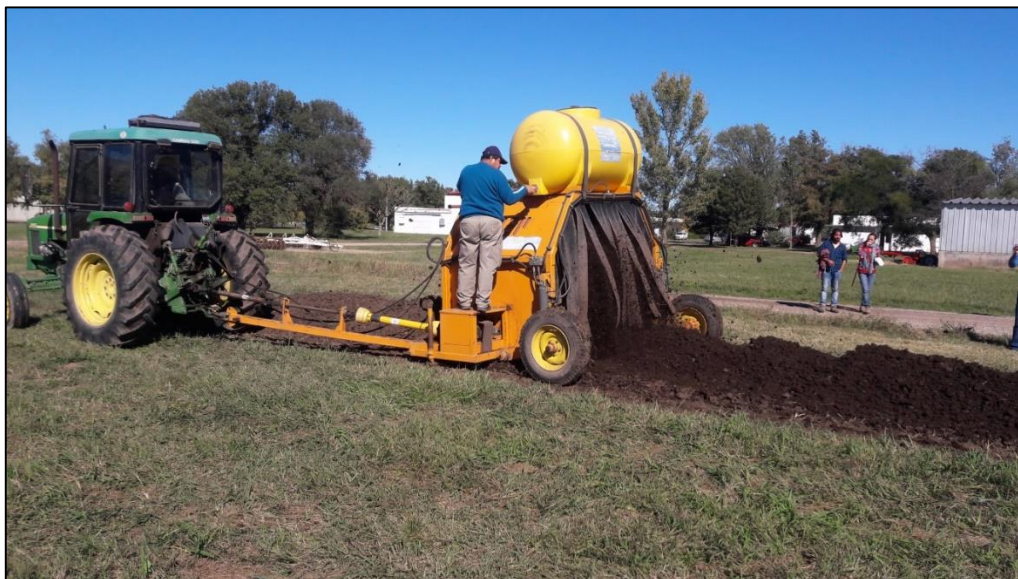
Figura 20: Maquina removedora de compost (EEA Marcos Juárez).
