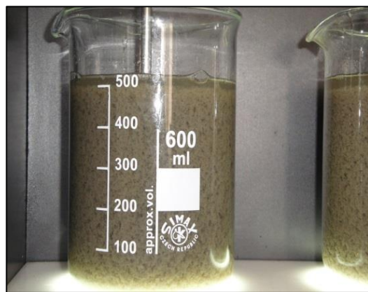
Figura 21: Prueba de efluente porcino con acondicionadores químicos.
