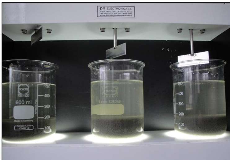
Figura 22: Equipo de Jar Test con efluente porcino, coagulado y floculado (Laboratorio de Transformación de los Residuos, IMyZA- INTA Castelar).
