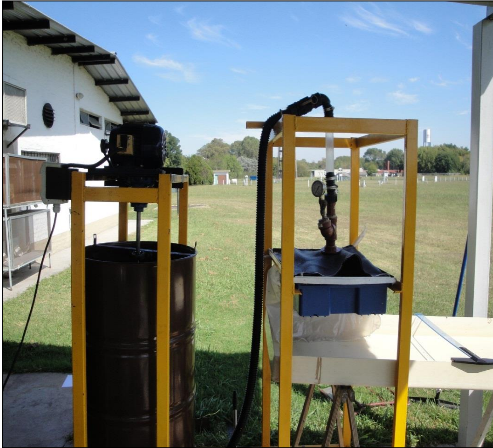
Figura 23: Dispositivo de geofiltración piloto (Laboratorio de Transformación de los Residuos, IMyZA- INTA Castelar).
