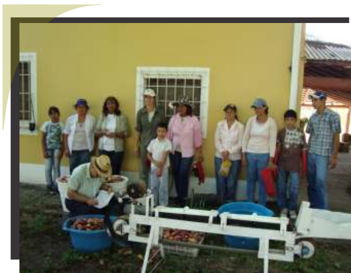
La máquina de la foto fué diseñada y construida por el Sr. Héctor Pochon, Charata Chaco, quita las espinas (janas) a través de cepillos con una eficiencia de 240 kilos de frutas de tuna en 17 minutos.
