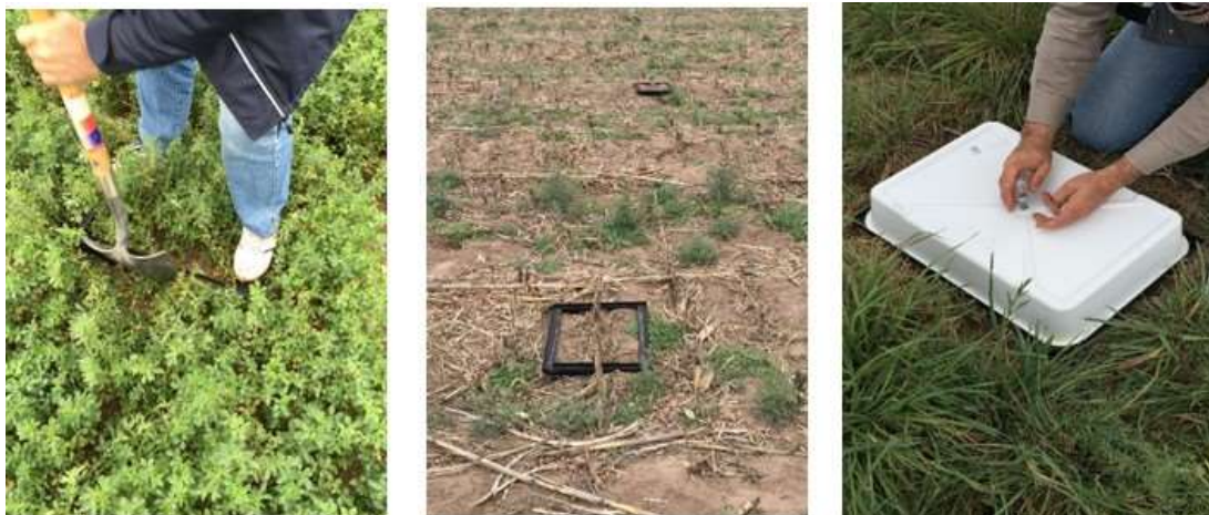
Figura 7.7: Imágenes del muestreo del N_2O mediante el método cámara cerrada no-estática en el ensayo de larga duración del campo experimental de la EEA.
