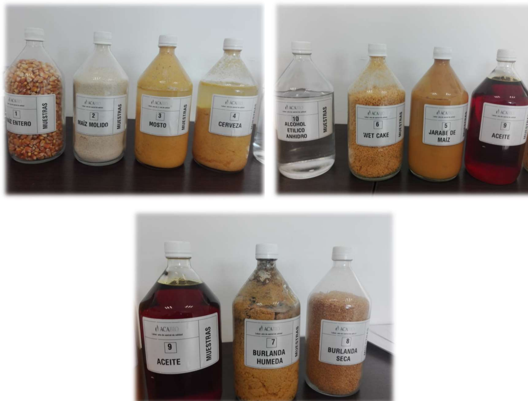
Figura 1.3. Subproductos de las distintas etapas de producción de bioetanol de maíz (ordenados de izquierda a derecha y de arriba hacia abajo, según su aparición en el proceso). Fuente: Propia, cortesía de ACABio.
