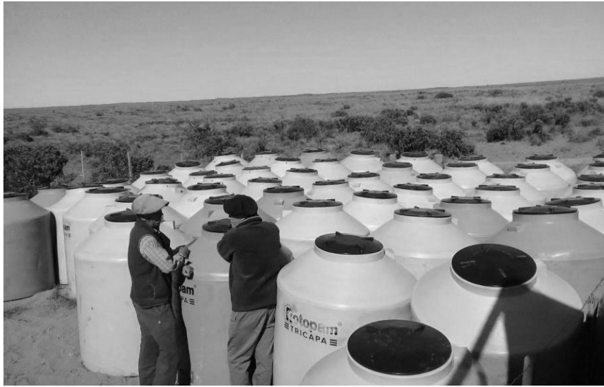
Figura 1: Tanques de almacenamiento tri-capa de 1100 litros de capacidad.
