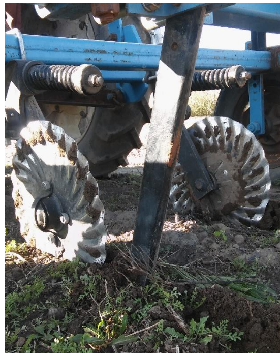
Figura 1: Implemento abre-surco para la plantación de ajo.
