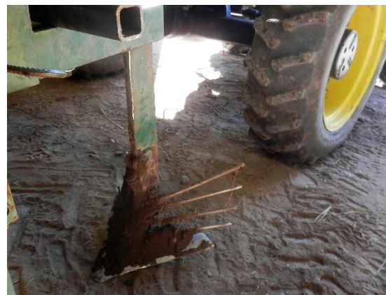
Figura 6: Dispositivo montado delante de las ruedas delanteras del tractor para la cosecha de cebolla.
