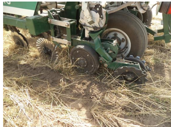
Figura 8: Tren de siembra directa compuesto por cuchilla de corte primario tipo “turbo”, abre-surco doble disco, ruedas limitadoras de profundidad laterales y doble rueda tapadora.
