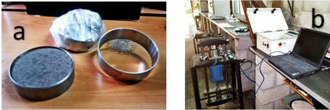
FIGURA 2.1: a) Muestra de suelo después de la prueba de precompresión, cilindros de acero inoxidable y una muestra de suelo extraída del sitio experimental, antes de la inmersión. b) Vista del equipo en su conjunto.
