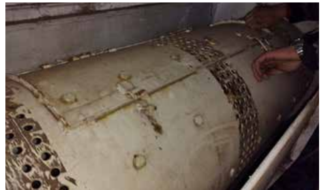
Figura 2.9 c: Tolva rotativa con carrera de agujeros calibrados y removedor pendular Westseeder (Vetore, OS)
