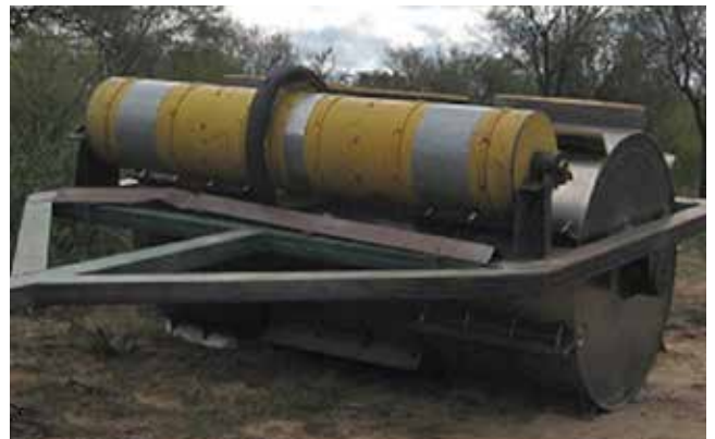
Figura 2.4 a: Tolva rotativa colocada en un rolo (a) (Privitello, MJL)
