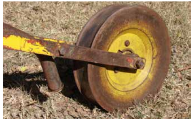
Figura 2.7 a: Compactador sunchado (Casagrande, J.)
