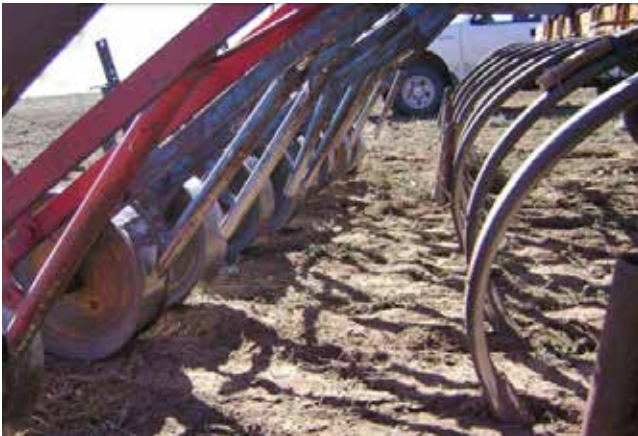
Figura 2.6 a: Cincel con compactadores sunchados y tubo de bajada delantero (Casagrande, J)
