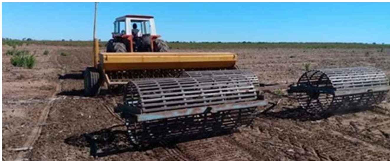
Figura 2.7 c: Rolo tipo jaula (Vetore, OS)
