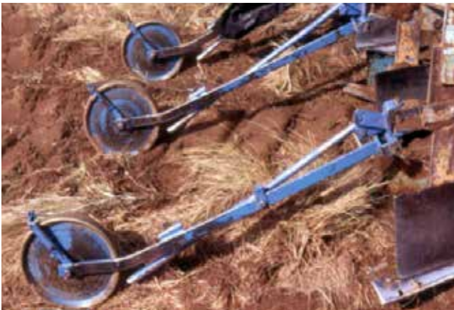
Figura 2.6 b: Pie de pato con compactadores sunchados y tubo de bajada delantero (Casagrande, J)
