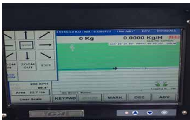
Figura 2.13 a: Monitor de banderillero satelital de altura y vista del interior de cabina.
