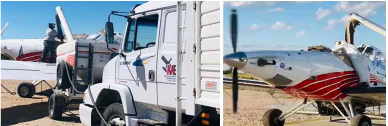
Figura 2. 11 b: Operación de carga de semilla desde camión hasta el avión (Ellena, M)
