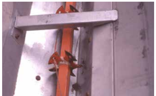
Figura 2.4 b: Tolva con removedor de semillas (Baeza, M)
