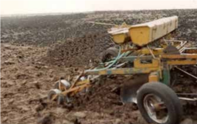
Figura 2.3 a: Arado Rastra o rastrón con tolva o cajón alfalfero y mínima labranza (INTA)
