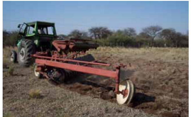
Figura 2.3 b: Arado rastra o rastrón con cajón alfalfero (Vetore, OS)
