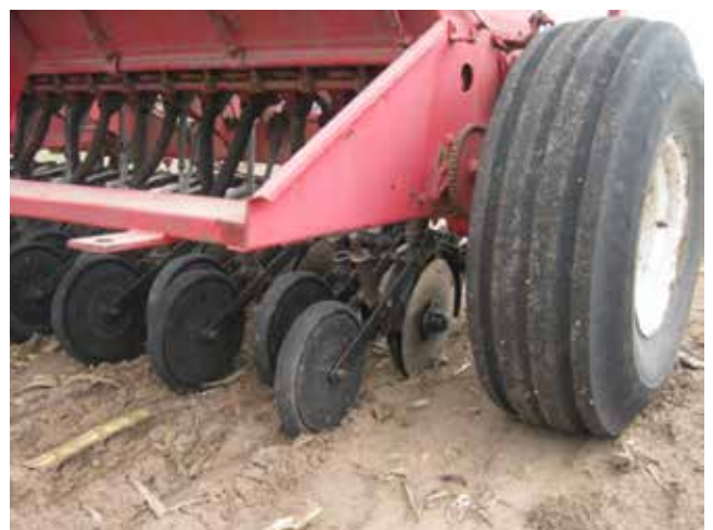
Figura 2.7 b: Compactador de línea fino (Vetore, OS)
