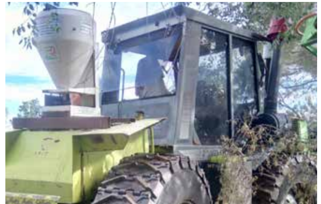
Figura 2.9 d: Tolva con distribución plato rotativo monodisco colocado sobre tractor. Preparado con protección de neumáticos para rolar en condiciones de bosque (Becerra, R)
