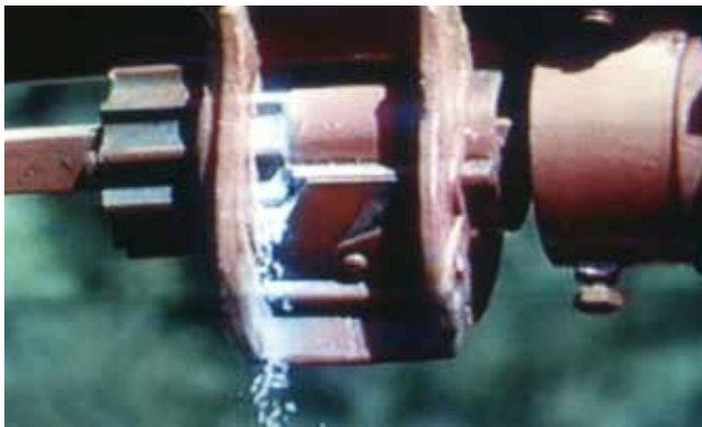
Figura 2.9 a: Dosificador a rodillo acanalado (Casangrande, J)
