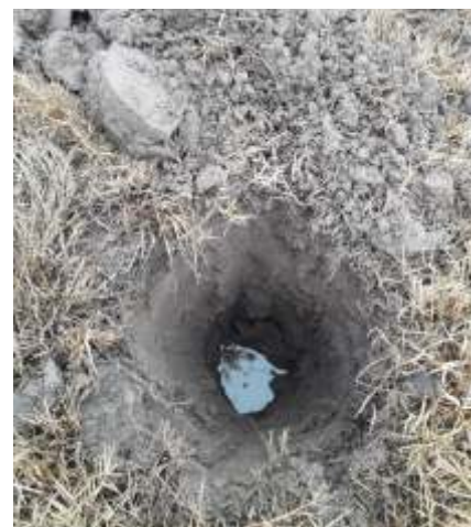
Figura 4: Pozo realizado con pala para registrar profundidad de napa freática (60 cm en este caso).
