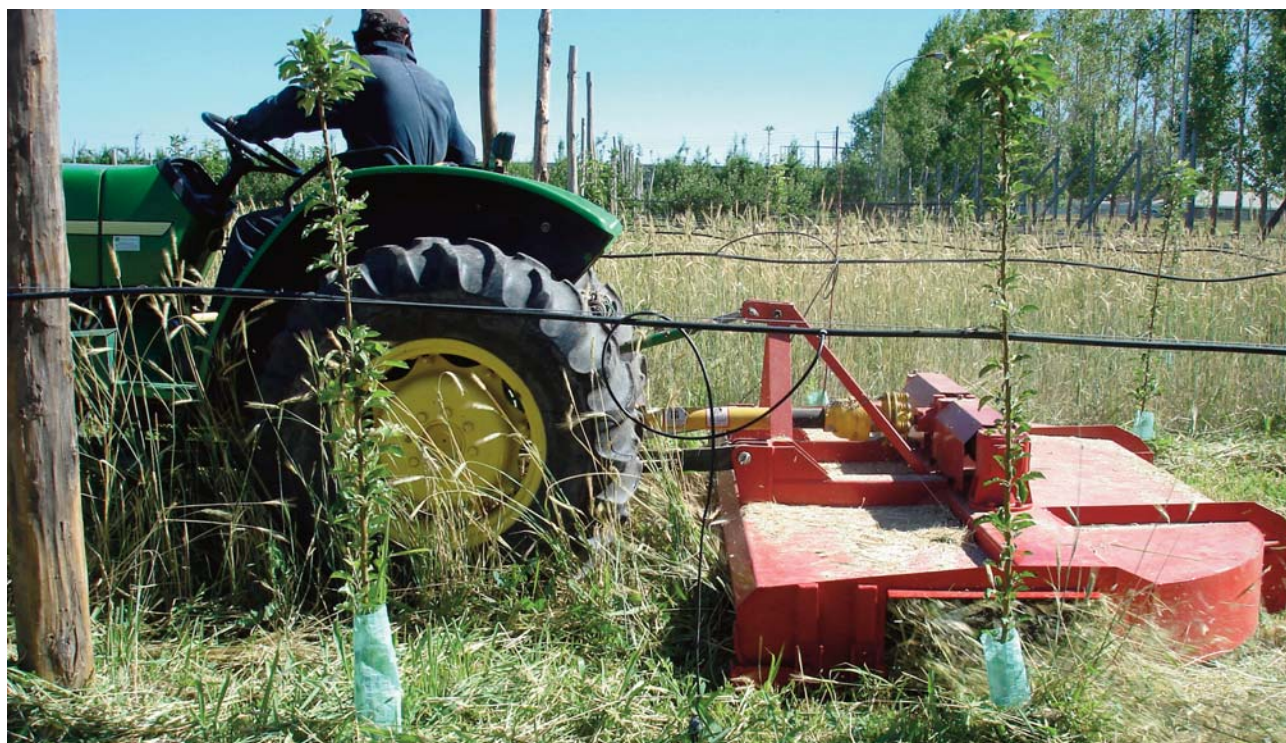
Corte de un verdeo de invierno con desbrozadora de 3 m de ancho y depósito lateral del material de corte sobre la fila.
