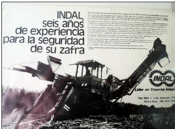
Figura 42. Cosechadora Indal ISA 221(Archivo de la familia Birgi, 2017). Nota: fue el modelo más avanzado de la fábrica, con un motor de mayor potencia y transmisión hidráulica tenía capacidad para cosechar caña en verde.
