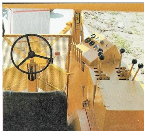
Figura 5. Cabina y controles de una cosechadora Cameco CH 1000 de los años 70. Fuente: Sugar y Azúcar (1977).
