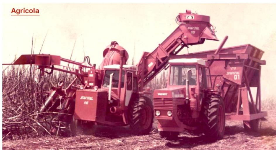
Figura 21. Cosechadora Santal 115. Una de las primeras integrales fabricadas en Brasil en la segunda parte de los años 1970 (Coelho, 2013). Nota: a la derecha se observa un carro autovuelco, similar a los actuales, pero con menor capacidad de carga.
