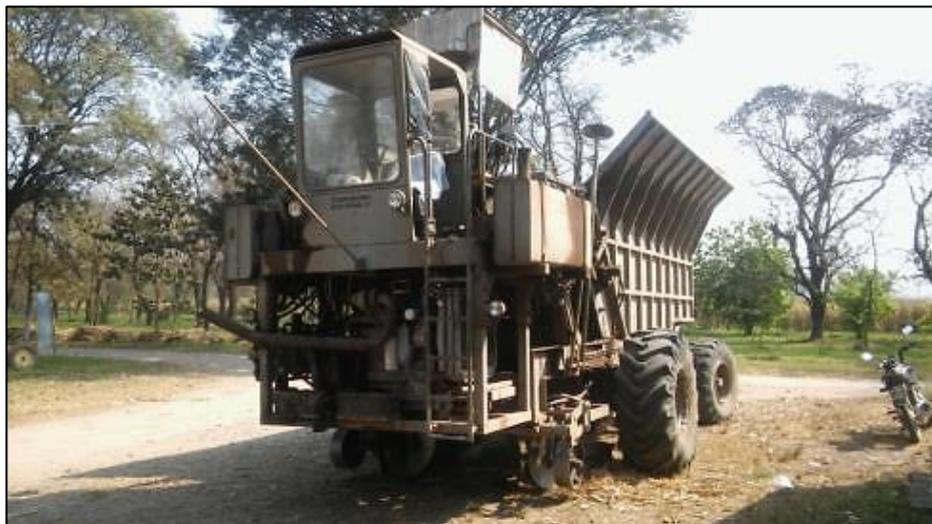
Figura 48. Plantadora autopropulsada de caña usada en la EEA Famaillá (2017). Nota: Diseñada y construida por el ingeniero agrónomo César Terán, se emplea desde hace varios años en los cañaverales tucumanos (EEA INTA Famaillá, 2017).
