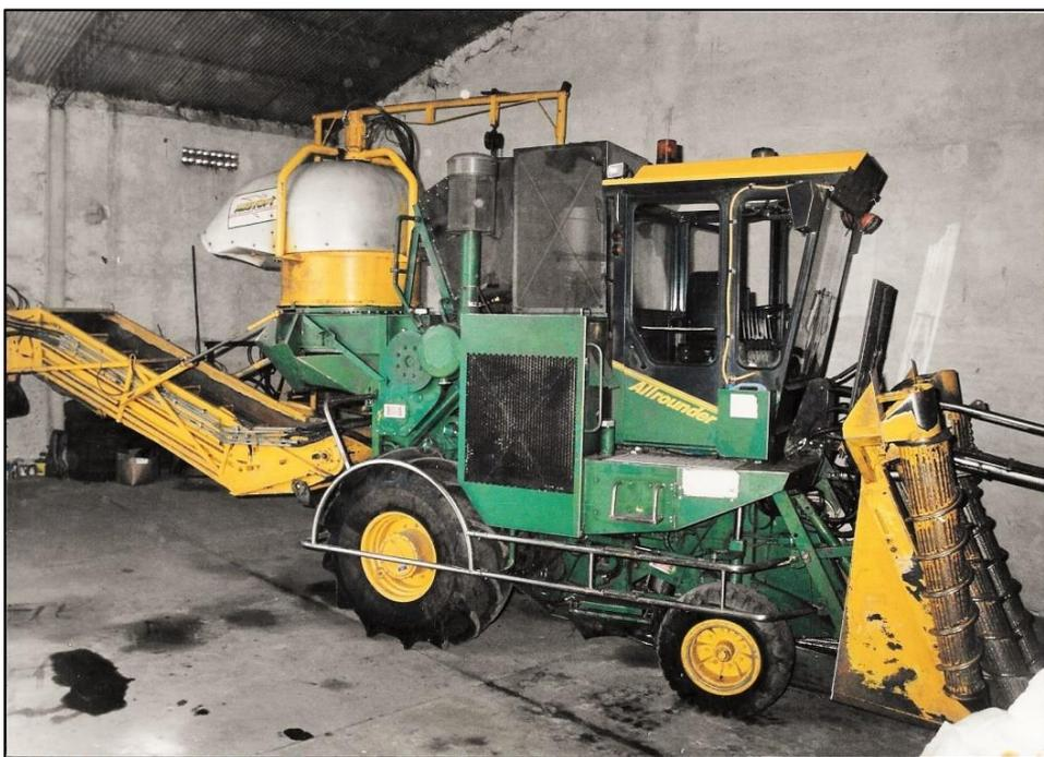
Figura 80. Cosechadora integral Austoft de la serie 7000. Nota: máquina empleada en la Cooperativa Ibatín durante la década de 1990 (AER INTA Monteros, 1995).
