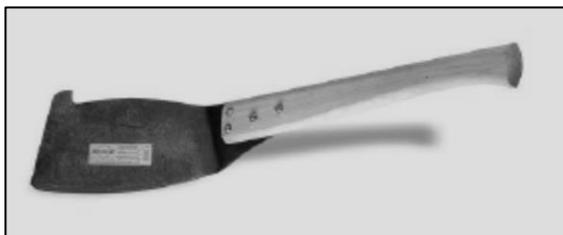
Figura 53. Machete «australiano» (Imacasa, 2017). Nota: En esencia una macheta con mango largo y perfil angulado de 135° para facilitar el corte.
