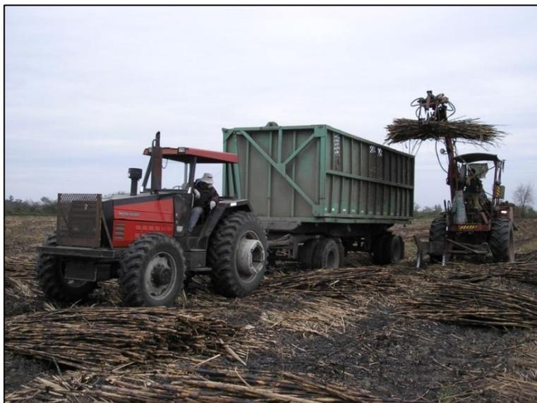
Figura 71. Máquina cargadora depositando caña en un carro tipo Java (AER Monteros, 2012).
