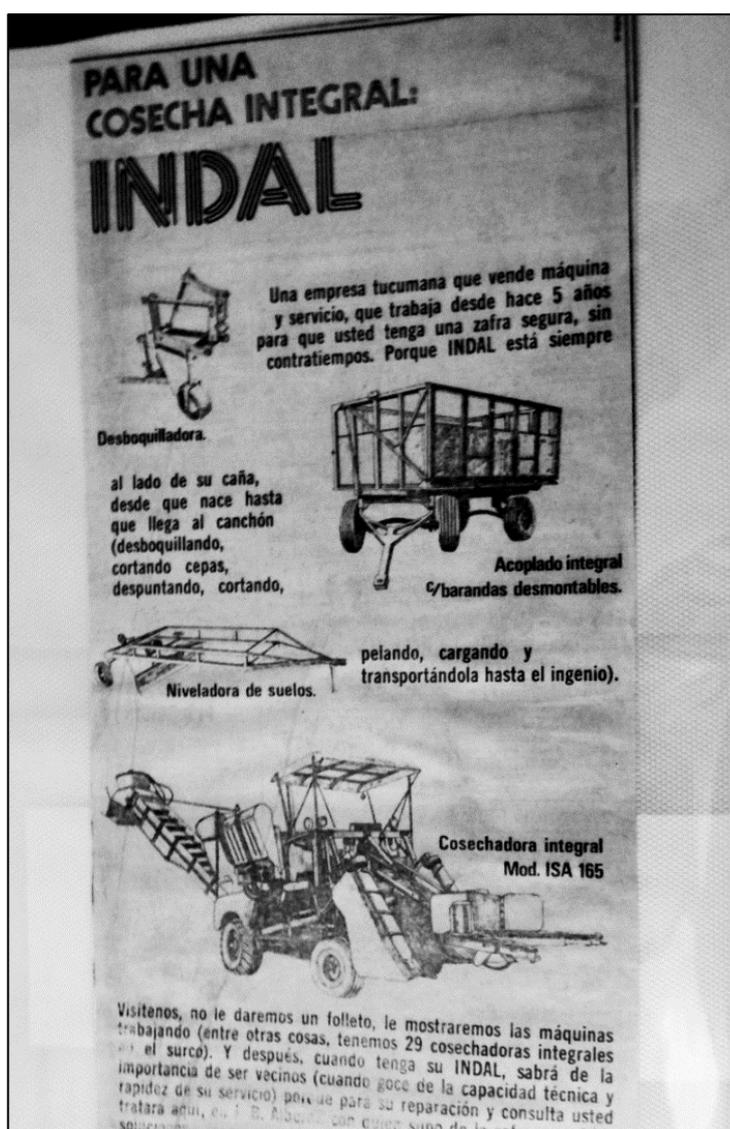
Figura 41. Productos fabricados por Indal a mediados de la década de 1970 (Archivo de la familia Birgi, 2017). Nota: La publicidad ofrece un «paquete» para la cosecha integral, compuesto por desboquilladora y niveladora, para preparar el suelo, el carro volquete para trasladar la caña y la ISA 165; el primer modelo tucumano de máquina integral.
