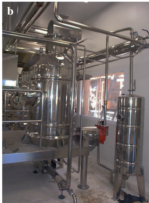
Figura 30: Paila al vacío calefaccionada con vapor. a) (gentileza Establecimiento Cabaña Micó, El Bolsón – Río Negro). b) (gentileza Corporación Macolla, Godoy Cruz – Mendoza). 37
