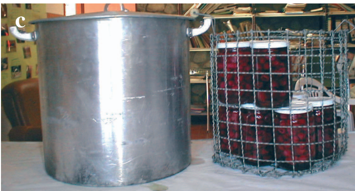
Figura 40: a) autoclaves; b) tanques discontinuos de pasteurización para producción de pequeña y mediana escala. c) Dispositivo para pasteurización hogareña a) 18 , b) 1 ) gentileza Dulcería Familia Mengoli, El Bolsón – Río Negro, b) 2 ) gentileza Establecimiento Masseur, El Hoyo - Chubut c) diseño del autor 37
