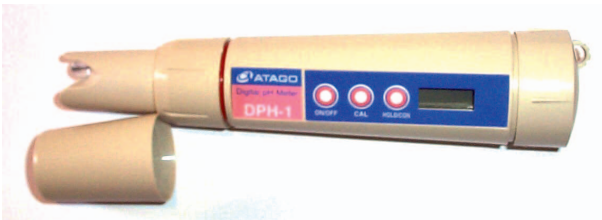
Figura 37: Peachímetro manual con electrodo de vidrio (Gentileza INTA AER El Bolsón. El Bolsón – Río Negro)
