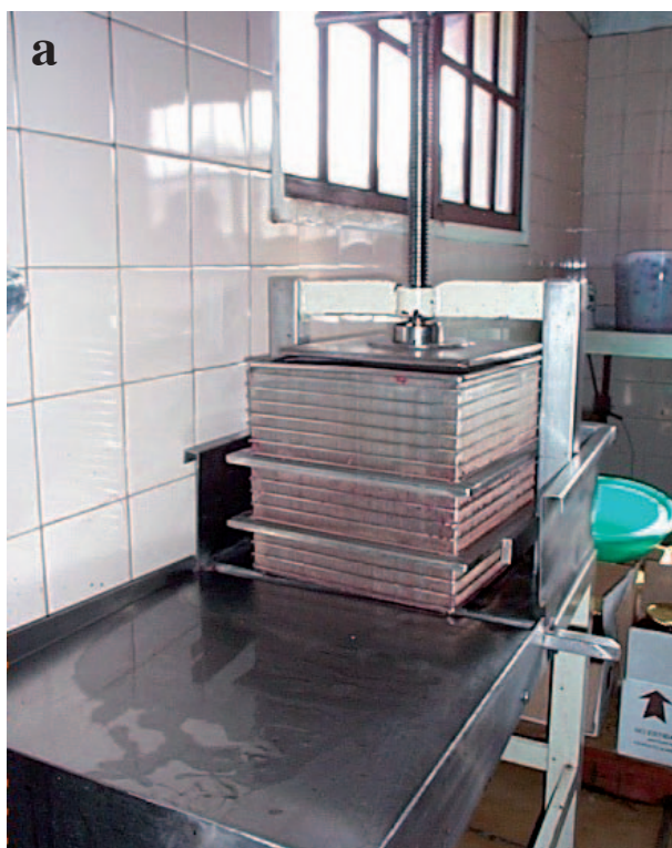
Figura 38: a) Filtro de acero inoxidable a presión con ayuda filtrante de tela (gentileza Establecimiento Belwel. San Martín de los Andes Neuquén); b) Juguera de pequeño tamaño comercial (gentileza de Tecnika) 51
