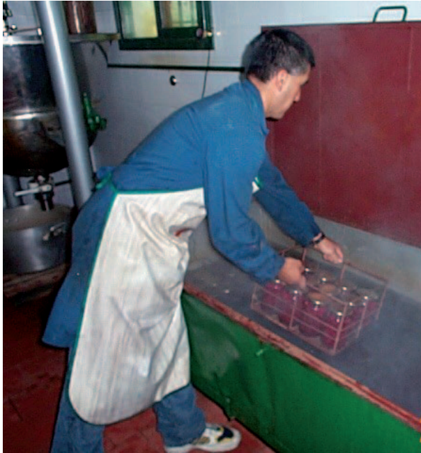
Colocando en el pasteurizador
