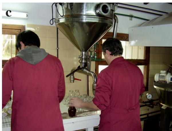
Figura 32: Batea calefaccionada para mantener el producto caliente y agitado mientras se envasa. a) Calefaccionada con mecheros (gentileza Establecimiento Masseur, El Hoyo Chubut). b) Calefaccionada con agua caliente (gentileza Cuyén s.r.l., El Hoyo – Chubut) c) Calefaccionada a vapor (gentileza Establecimiento El Puente, Las Golondrinas – Chubut) 37
