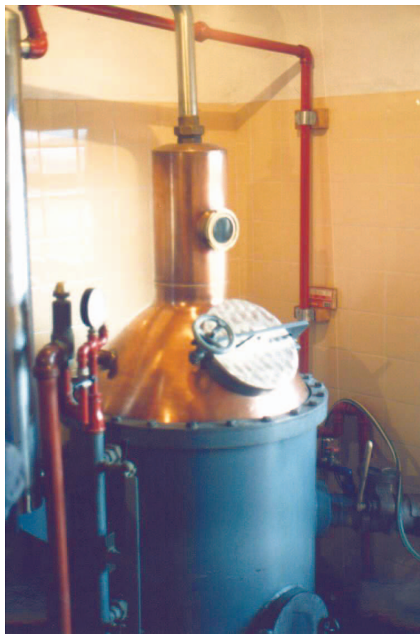
Figura 46: Alambique para la destilación de líquidos alcohólicos (gentileza Establecimiento El Puente, Las Golondrinas, Lago Puelo – Chubut)
