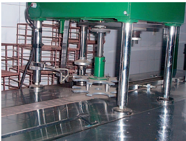
Figura 34: tapadora semiautomática con estrella intercambiable para distintos tipos de frascos. (gentileza Dulcería Familia Mengoli, El Bolsón – Río Negro) 37
