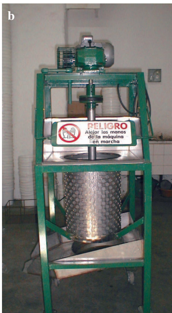
Figura 24: Máquinas pulpadoras. (a) De acción horizontal, continua (gentileza Cuyén s.r.l., El Hoyo – Chubut). (b) De acción vertical, discontinua (gentileza Dulcería Familia Mengoli. El Bolsón – Río Negro) 37
