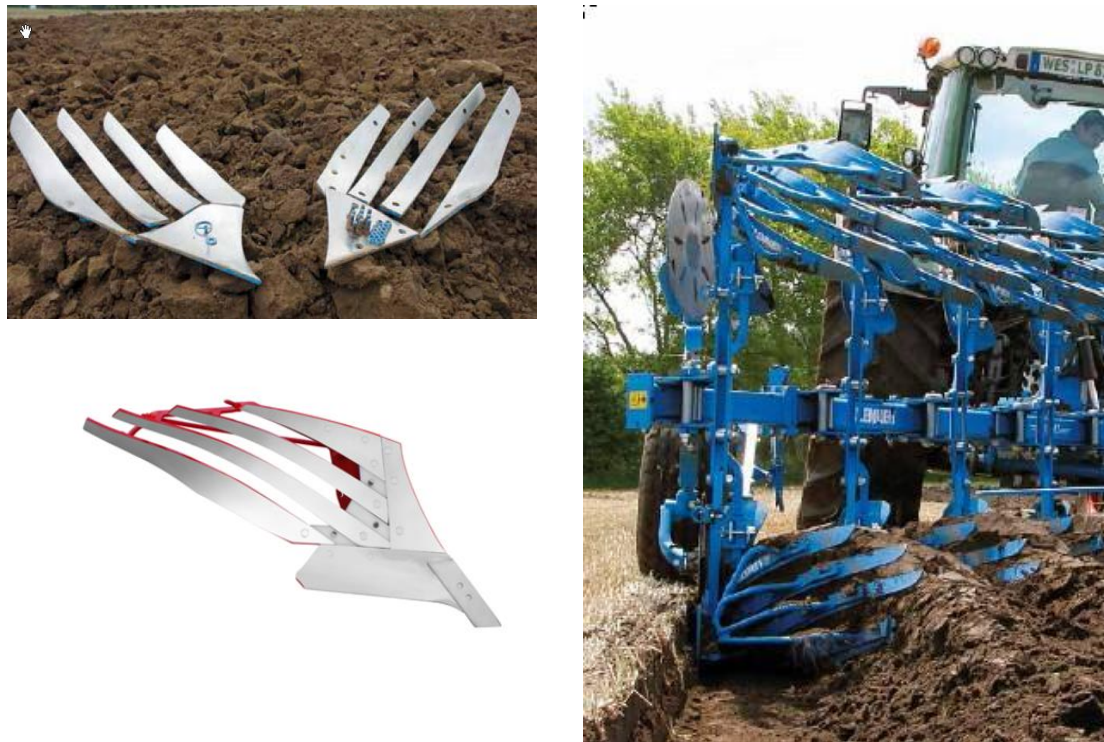
Figura 7: Detalle de unas vertederas listonadas y de un arado reversible provisto con este tipo de vertederas. Fuente: Lemken (2016).
