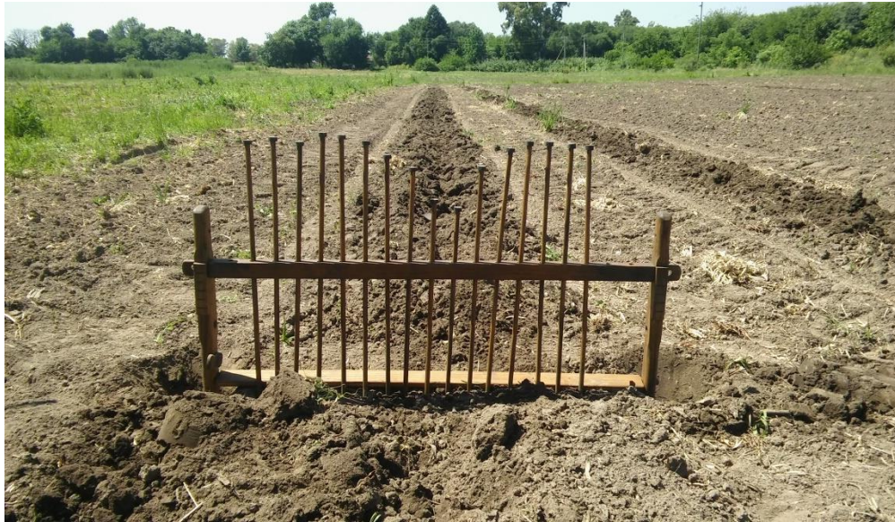
Figura 21: Detalle del perfilómetro utilizado para determinar el área removida luego del laboreo de las púas.
