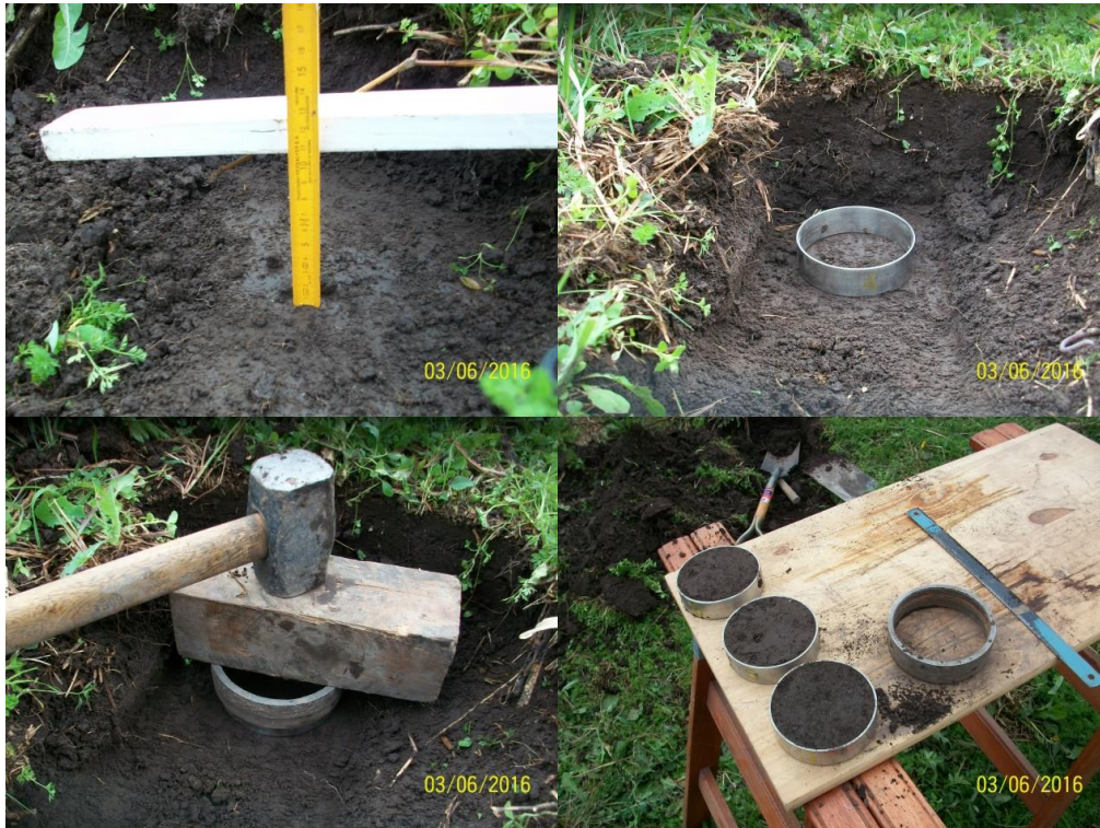
Figura 14: Detalle de la secuencia de extracción de muestras sobre las cuales se midió la adhesión normal entre el suelo y el metal.
