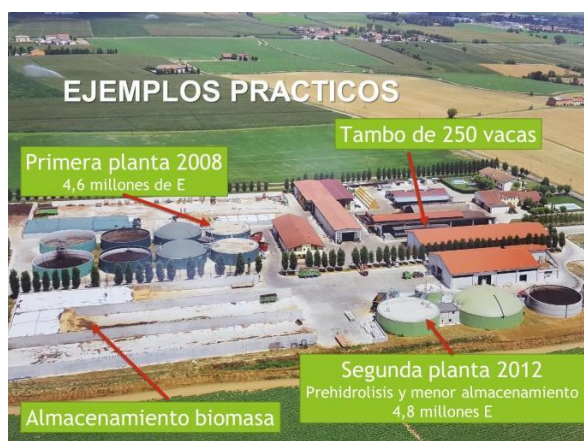
Figura. 2. Planta de Biogas integrada bajo el principio BDR.
