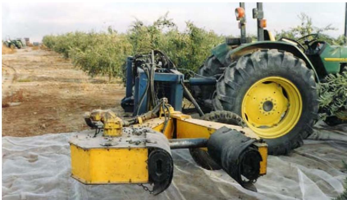
Los movimientos del brazo vibrador dependen de un mecanismo hidráulico que funciona mediante la toma de fuerza del tractor.
